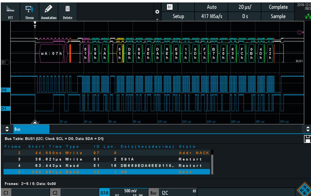
已解码的十六进制 I<sup>2</sup>C 信息以蜂巢形式显示，并列入解码表中。
